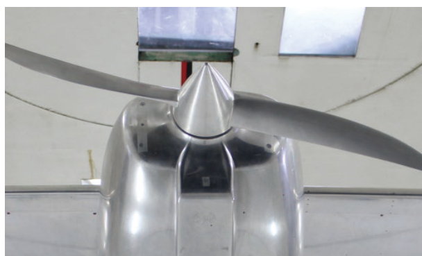
图 5 单发螺旋桨飞机进气口在风洞模型上的简化
